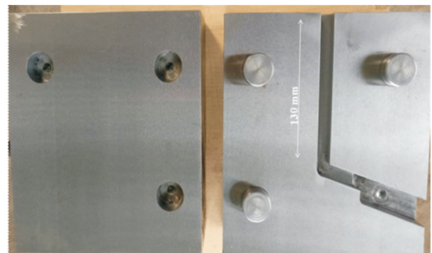
Figure 3. ECAP Die Dimensions
